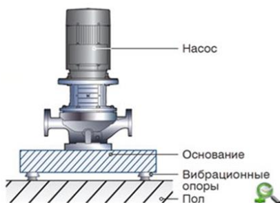
Рис.10.2 Способы монтажа насосного оборудования
